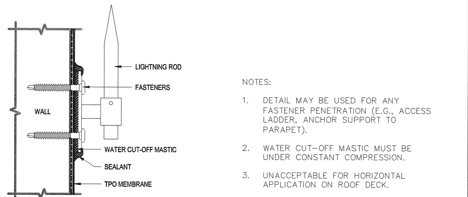
**F9** LIGHTNING ROD AT PARAPET
