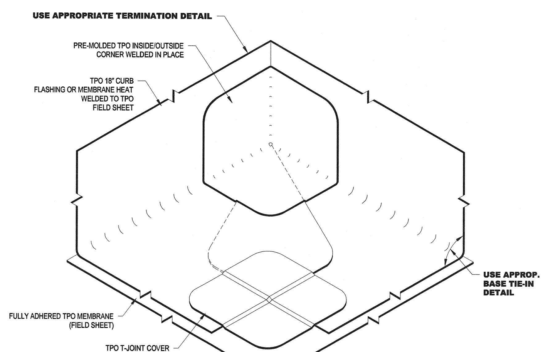
**L14** INSIDE CORNER SEPARATE TPO FLASHING
